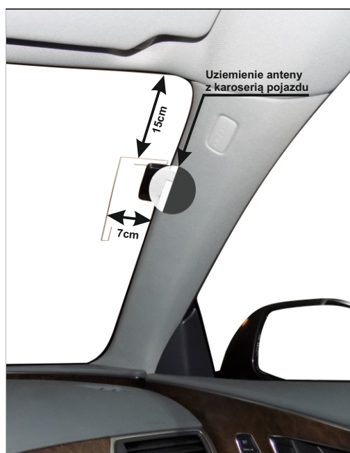
Przykład zamontowania anteny DAB/DAB+
