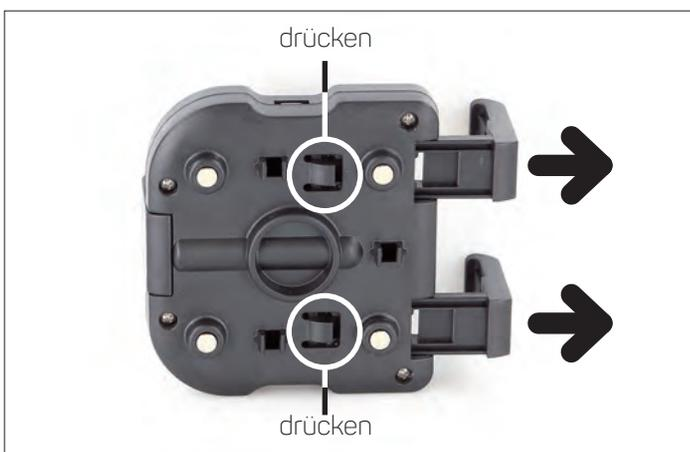
(3) Die Haltebügel des Inbay Lüftungshalters können durch Betätigung der Entriegelung (siehe markierte Flächen) nach außen gezogen werden.
