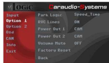
3 **Ausnahme:** Sollte das System nach der Installation und dem hier beschriebenen OSD-Setup (Option 2 / Cam Trigger - „CAN“, siehe nächstes Kapitel) nicht automatisch mit dem aktivierten Rückwärtsgang auf die After-Market Rückfahrkamera umschalten, so muss das weiße Kabel des Kabelsatzes V6C-NAC01 mit einem analogen Rückfahrsignal (+12V) angeschlossen und die Menüeinstellung Option 2 / Cam Trigger - „Analogue“ eingestellt werden.
